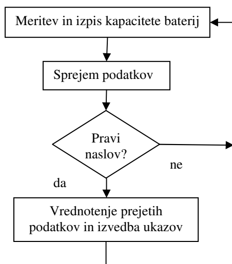
Slika 9: Poenostavljen diagram poteka 2. mikrokrmilnika
