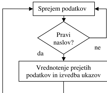
Slika 8: Poenostavljen diagram poteka 1. mikrokrmilnika
